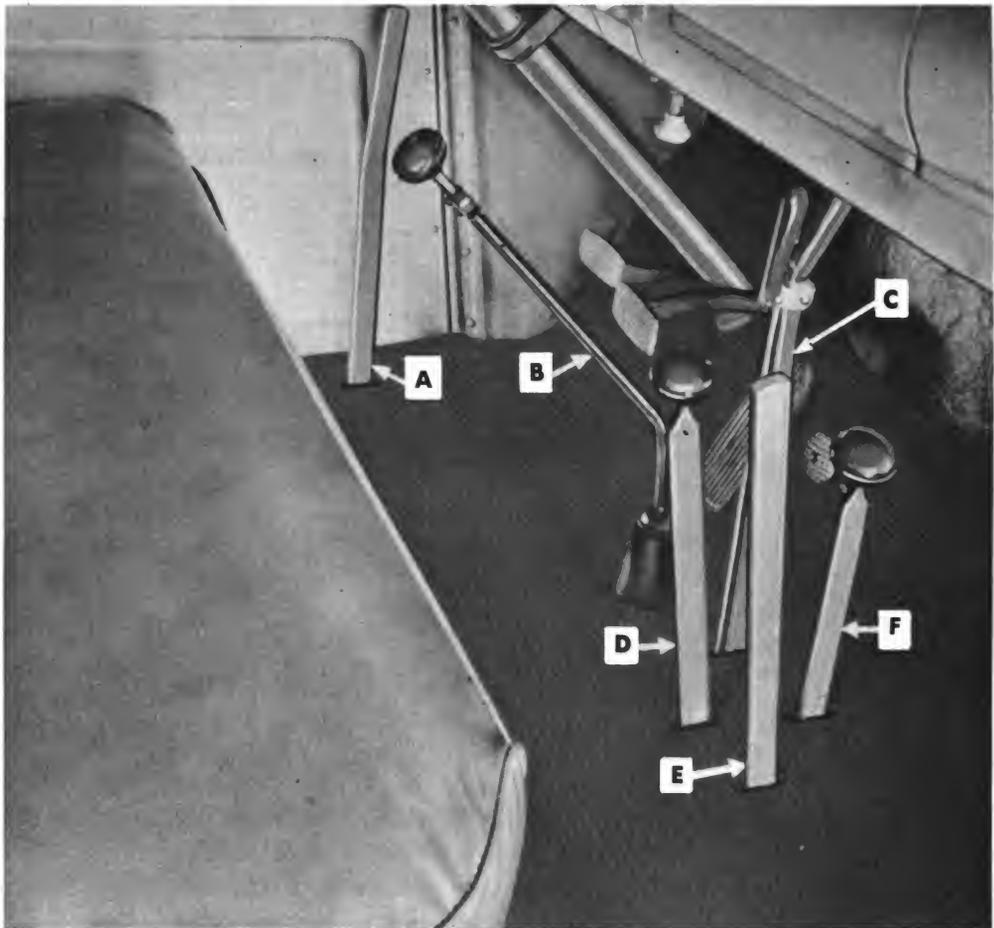
**A**—WINCH CLUTCH AND BRAKE CONTROL LEVER
